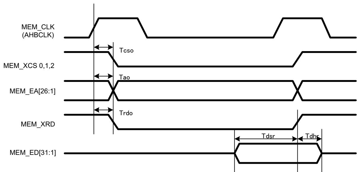
**Figure 2.11. :** SRAM/NOR Flash Read
