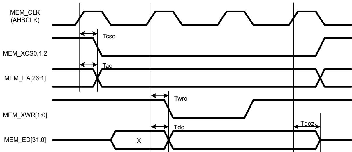
**Figure 2.12. :** SRAM/NOR Flash Write
